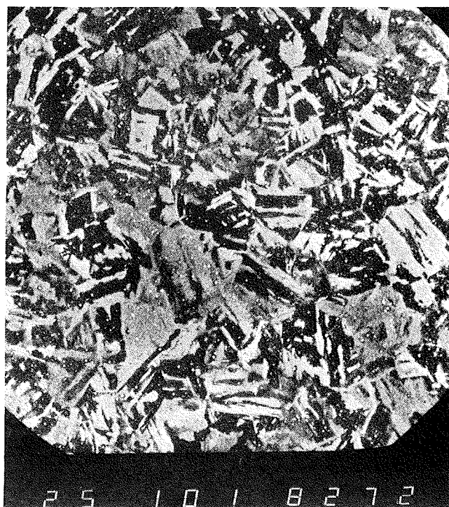
Slika 6: pov. 100x. Zlitina A. Posneto v SEM. Mikrostruktura po gašenju s temperature 1200°C.
