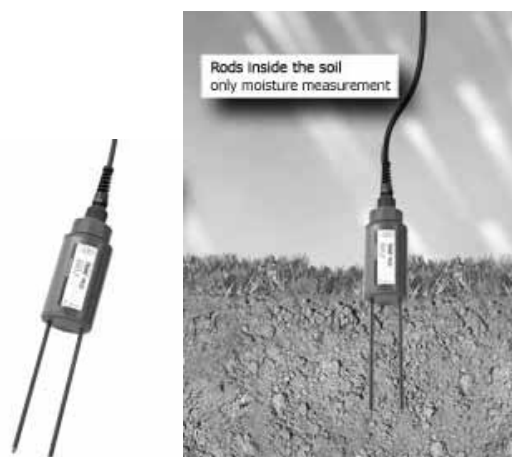
Slika 8. Senzor za zajemanje merilnih podatkov na terenu in njegova uporaba.
